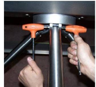
Die Schrauben mit 5 mm Inbus-schlüssel fest anziehen
