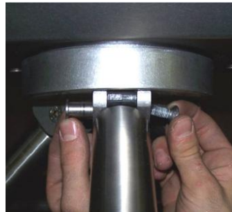
Sperrarme mit je 1x Innen-sechskantschraube befestigen
