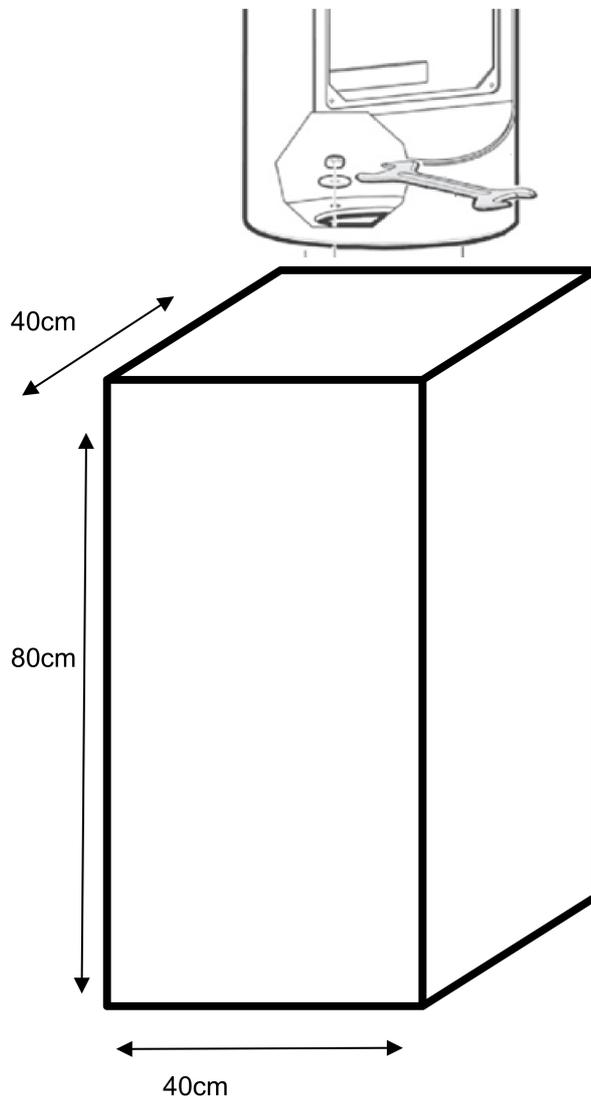
**Zuführung Leerrohr Mitte Fundament max. DN80**
